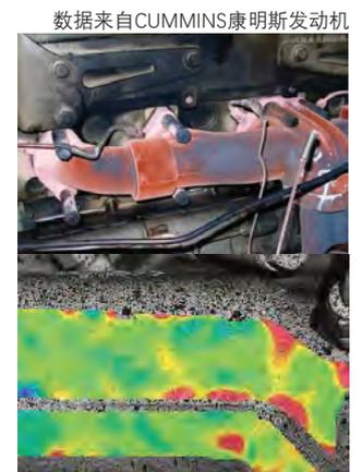
发动机排气管热载荷试验
